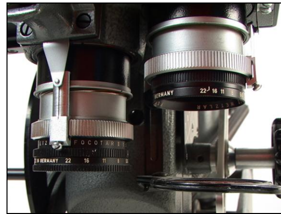
Links das FOCOTAR-II 1:5,6/100, rechts das FOCOTAR 1:4,5/60 mm
